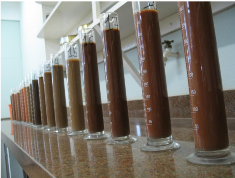
Figura 6: Decantação para determinação da argila
