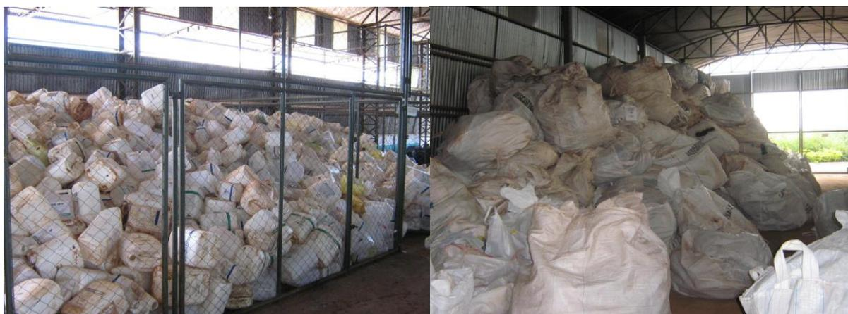
**Figura 6: Separação em gaiolas – Rígidas**      **Figura 7: Embalagens flexíveis em BAGs**
