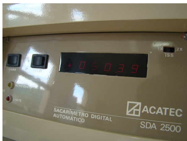
Leitura da calibração do tubo de quartzo
