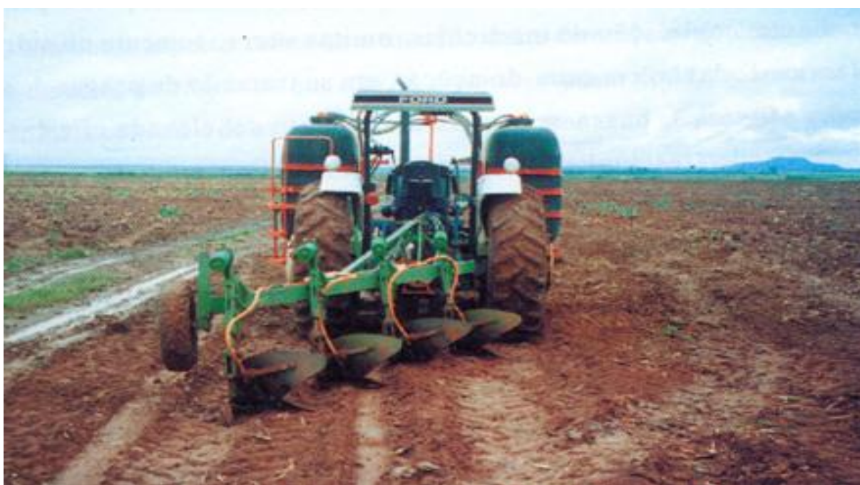
Figura. 7. Aplicador de inseticida de solo com arado de aiveca – Barreira química
