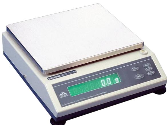
Fig.21. Balança semi-analítica
